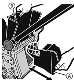
Рис. 3 Установка заглушки для мульчирования
