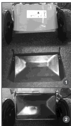
Рис. 4 Установка желоба заднего выброса
